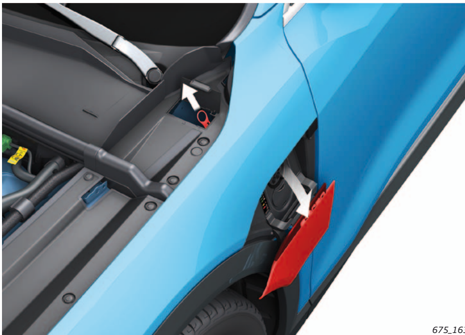
Déverrouillage de secours du trappe de recharge
